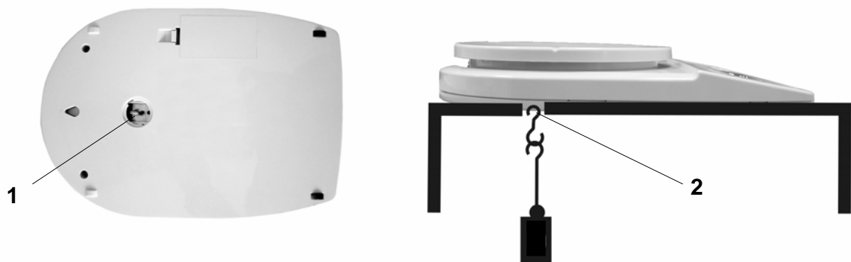
Abb. 1: Einrichten der Waage für Unterflurwägungen
