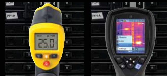
Pyrometer, Temperaturmessung an einem Punkt
