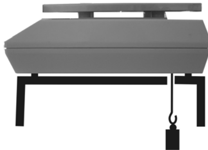
Abb. 1: Einrichten der Waage für Unterflurwägungen
