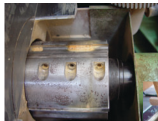
Holzwerkzeuge vor und nach der Reinigung mit SONOREX-Ultraschall und TICKOPUR R 33.
