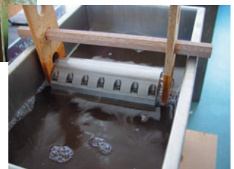
Holzwerkzeuge vor und nach der Reinigung mit SONOREX-Ultraschall und TICKOPUR R 33.
