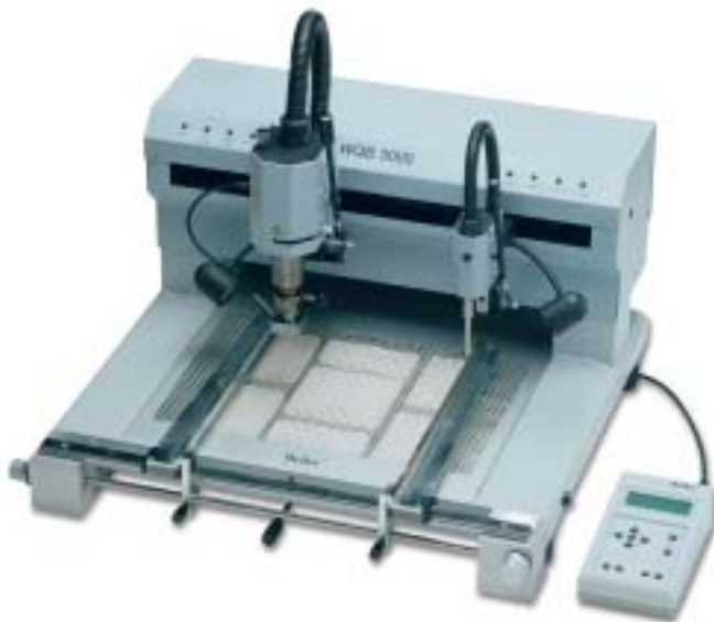
WQB 3000 BGA/SMT Reparatursystem für die Bauteilbestückung mit Schablonen
