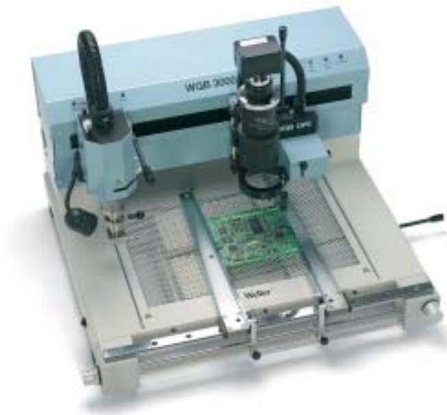
WQB 3000OPS BGA/SMT Reparatursystem für die Bauteilbestückung mit kameraunterstütztem Positioniersystem
